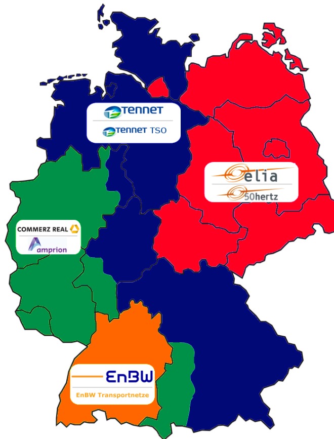
Abb. 3: Regelzonen der Hoch- und Höchstspannungsnetzbetreiber 29
